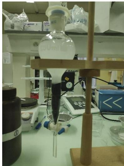
**Figure 8.** Ampoule à décanter contenant des sédiments  $<500\mu\text{m}$  et 200mL de solution saturée en NaCL
