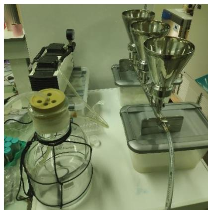
**Figure 9.** Colonnes de filtration avec un système de pompage à vide
