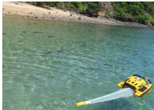
**Figure 6.** Echantillonnage des MP à la surface de l'eau réalisé à l'aide d'un filet à plancton tiré par un robot ("JellyFishBot")
