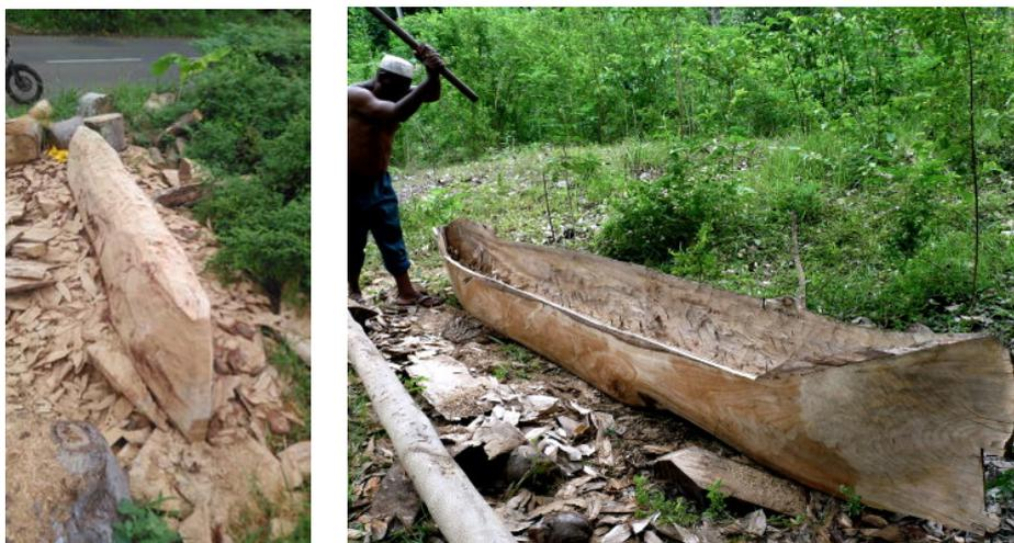
Figure 25 – Equarrissage et creusage sur lieux de coupe de l'arbre
