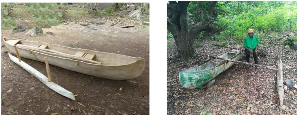
Figure 26 – Pirogue monoxyle prête à être assemblés (à gauche)
